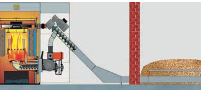
Vue en coupe d'un système de chauffage à pellets entièrement automatique.
