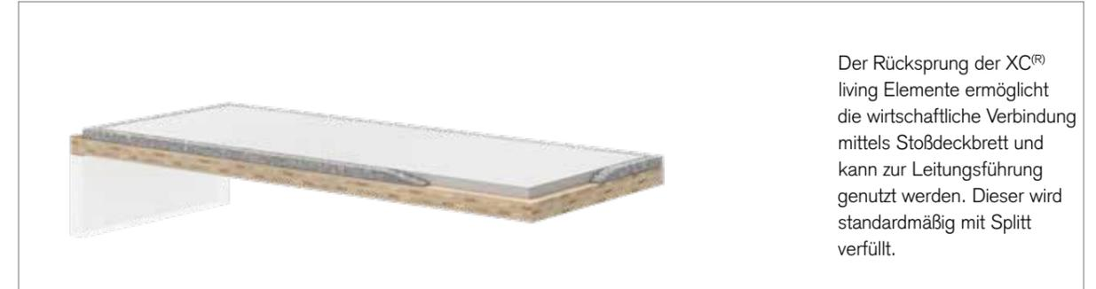
Der Rücksprung der XC<sup>®</sup> living Elemente ermöglicht die wirtschaftliche Verbindung mittels Stoßdeckbrett und kann zur Leitungsführung genutzt werden. Dieser wird standardmäßig mit Splitt verfüllt.
