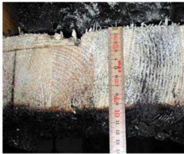
Abbildung 58: Restholzquerschnitt im Bereich der Fuge bei Falzbrettverbindung
