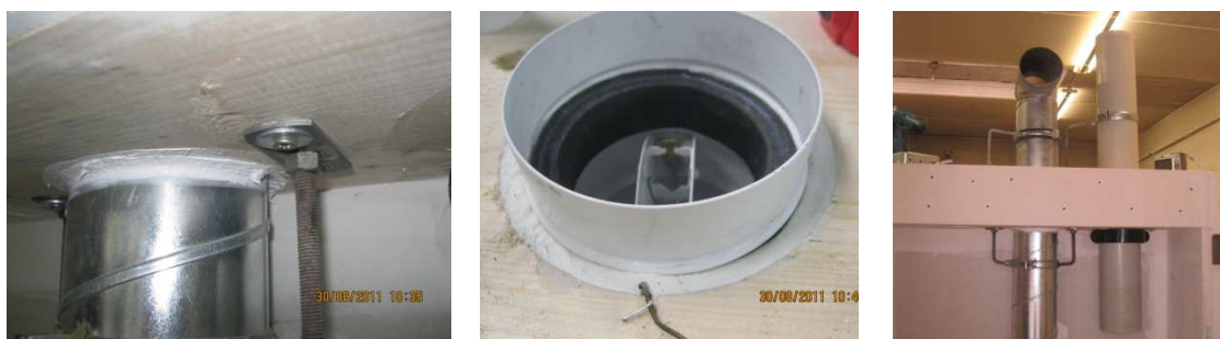
Abbildung 91: Starre Befestigung des Lüftungsrohres in der Holzdecke (links), Feuerschutzabschluss auf Basis intumeszierender Materialien mit Verschlusselement FLI-VE (Mitte), Einbau in Probekörper (rechts)
