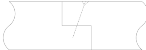
Abbildung 59: Restholzquerschnitt im Bereich der Fuge bei Stufenfalzverbindung
