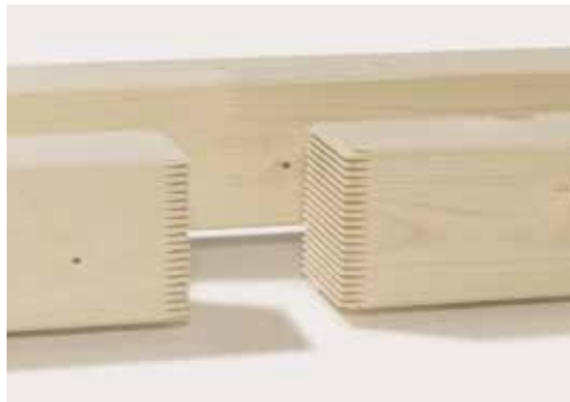
Abb. 3.4: Keilzinkenverbindung bei Konstruktionsvollholz nicht im bewitterten Außenbereich geeignet
